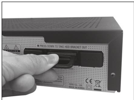
Entfernen Sie die Festplatte indem Sie den Einbaurahmen an der Lasche herausziehen.
