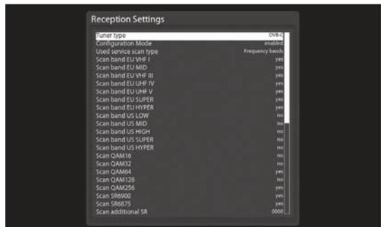
4. Mit den LINKS/RECHTS Tasten können Sie zwischen DVB-C und DVB-T/T2 Modus wählen. Bestätigen Sie mit der OK Taste.
