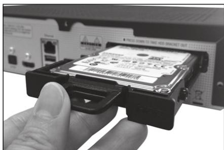
Schieben Sie den Einbaurahmen einfach in die SOLO 4K
