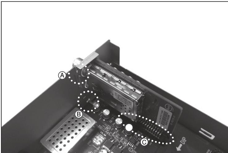
Wenn Sie einen Tuner selbst installieren, stellen Sie sicher, dass die 3 markierten Bereiche korrekt sitzen.
