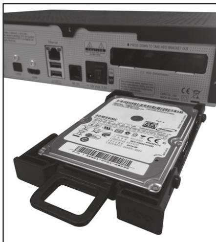
Legen Sie eine 2.5" HDD in den Einbaurahmen. Es empfiehlt sich die Festplatte mit Schrauben im Rahmen zu fixieren.
