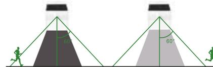
**Modus B:** Schaltet automatisch auf volle Helligkeit (400 lm) wenn eine Bewegung im Bereich von 6 m erfasst wird und wechselt dann, wenn keine Bewegung zu erkennen ist, auf 3% Helligkeit runter.
