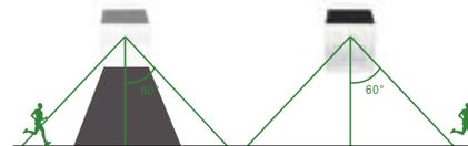
**Modus C:** Schaltet automatisch auf volle Helligkeit (400 lm) wenn eine Bewegung in dem Bereich von 6 m erkannt wird. Danach schaltet sich die Leuchte nach 30 Sekunden aus.
