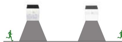
**Modus A:** Schaltet sich automatisch in der Dämmerung oder Umgebungshelligkeit von  $< 30$  lux ein und leuchtet mit 20% der vollen Helligkeit bis zu 5 Stunden weiter. Danach schaltet sich die Solarleuchte aus.
