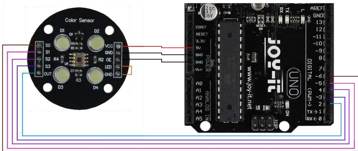
Bild 2: Verkabelung mit Arduino
