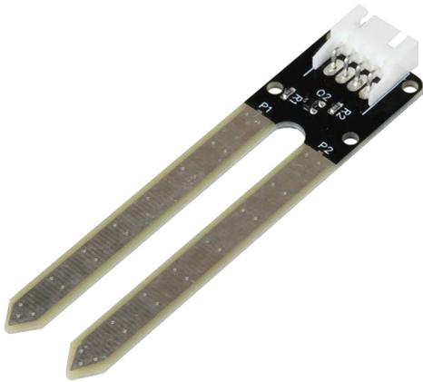
Der SEN-Moisture bietet mit seinen zwei langen Fühlern ein optimales Ergebnis und eignet sich hervorragend für z.B. eine automatische Bewässerungsanlage.
