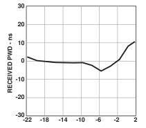
P<sub>RL</sub> - RECEIVER OPTICAL INPUT POWER - dBm
