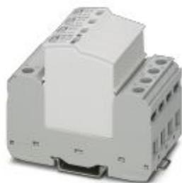
Steckbarer Überspannungsableiter, gem. Typ 2 / Class II, für 3-phasige Stromversorgungsnetze mit separatem N und PE (5-Leitersystem: L1, L2, L3, N, PE). Mit 40 kA Ableitvermögen gemäß Anforderungen der VDE 0100-534:2016-10 an SPDs am Speisepunkt der Anlage.
