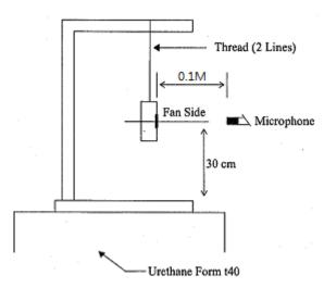
0.1 METER FROM MICROPHONE TO FAN INTAKE
