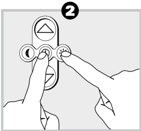
**2 Grenzwert der Sonnenautomatik einstellen:** Betätigen Sie kurz gleichzeitig die [Sonnen]- und [Uhr]-Taste. Die Speicherung des Grenzwertes wird durch kurzes Aufblinken des Sonnensymbols bestätigt.
