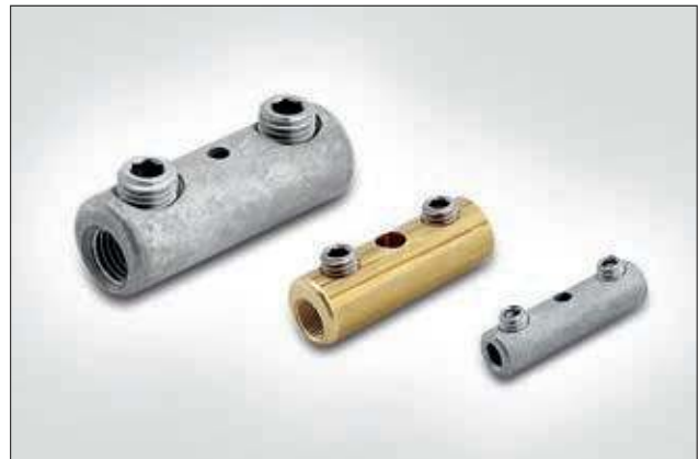
Verzinte Schraubverbinder ohne Trennsteg mit Sichtloch, für Al- und Cu-Leiter.
