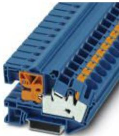
N-Trennklemme, Push-in-Anschluss, Querschnitt: 0,5 mm<sup>2</sup> - 16 mm<sup>2</sup>, AWG: 24 - 4, Breite: 10,2 mm, Farbe: blau, Montageart: NS 35/7,5, NS 35/15
