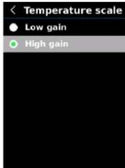
Auf der Einstellungsschnittstelle drücken Sie die Taste „Auf/Ab“, um „Temperaturskala“ auszuwählen, und drücken Sie die Taste „Einstellung“, um die Einstellungsschnittstelle für Skala aufzurufen. Drücken Sie die Taste „Auf/Ab“, um „High-gain/Low-gain“ auszuwählen, und drücken Sie die Taste „Einstellung“, um zu bestätigen. Drücken Sie die Taste „Zurück“, um zur vorherigen Schnittstelle zurückzukehren.
