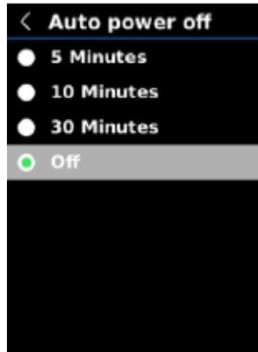
Auf der Einstellungsschnittstelle drücken Sie die Taste „Auf/Ab“, um „Automatisches Ausschalten“ auszuwählen, und drücken Sie die Taste „Einstellung“, um ihre Einstellungsschnittstelle aufzurufen. Drücken Sie die Taste „Auf/Ab“, um „5 Minuten/10 Minuten/30 Minuten/Aus“ auszuwählen, und drücken Sie die Taste „Einstellung“, um zu bestätigen. Drücken Sie die Taste „Zurück“, um zur vorherigen Schnittstelle zurückzukehren.
