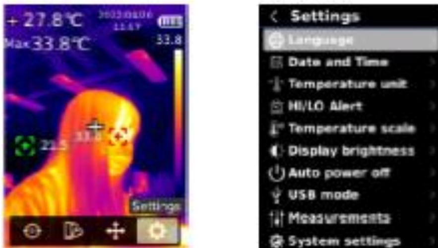
Auf der Hauptschnittstelle drücken Sie die Taste „Einstellung“, um das Hauptmenü aufzurufen. Drücken Sie die Taste „Links/Rechts“, um „Einstellungen“ auszuwählen, und drücken Sie die Taste „Einstellung“, um das Submenü aufzurufen. Drücken Sie die Taste „Auf/Ab“, um eine Option im Submenü auszuwählen, und drücken Sie die Taste „Einstellung“, um die Einstellungsschnittstelle aufzurufen. Drücken Sie die Taste „Zurück“, um zur vorherigen Schnittstelle zurückzukehren.
