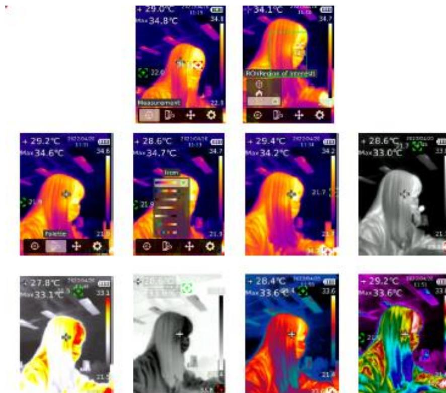
Auf der Hauptschnittstelle drücken Sie die Taste „Einstellung“, um das Hauptmenü aufzurufen. Drücken Sie die Taste „Links/Rechts“, um „Palette“ auszuwählen, und drücken Sie die Taste „Einstellung“, um das Submenü aufzurufen. Drücken Sie die Taste „Auf/Ab“, um eine Palette auszuwählen. Drücken Sie die Taste „Zurück“, um zur vorherigen Schnittstelle zurückzukehren.
