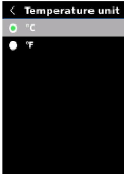
Auf der Einstellungsschnittstelle drücken Sie die Taste „Auf/Ab“, um „Temperatureinheit“ auszuwählen, und drücken Sie die Taste „Einstellung“, um die Einstellungsschnittstelle aufzurufen. Drücken Sie die Taste „Auf/Ab“, um „°C/°F“ auszuwählen, und drücken Sie die Taste „Einstellung“, um zu bestätigen. Drücken Sie die Taste „Zurück“, um zur vorherigen Schnittstelle zurückzukehren.
