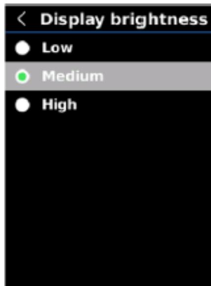
Auf der Einstellungsschnittstelle drücken Sie die Taste „Auf/Ab“, um „Anzeigehelligkeit“ auszuwählen, und drücken Sie die Taste „Einstellung“, um die Einstellungsschnittstelle für Helligkeit aufzurufen. Drücken Sie die Taste „Auf/Ab“, um „Niedrig/Mittler/Hoch“ auszuwählen, und drücken Sie die Taste „Einstellung“, um zu bestätigen. Drücken Sie die Taste „Zurück“, um zur vorherigen Schnittstelle zurückzukehren.
