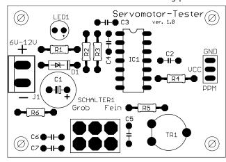
Achtung: Die Dioide D1 kann sowohl in zylindrischer als auch in kugelform im Bausatz enthalten sein!
