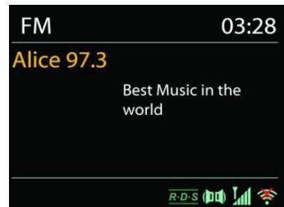
Für die automatische Suche eines Radiosenders drücken und halten Sie die „**INTRO**“ Taste. Die Frequenzanzeige beginnt zu laufen und speichert alle verfügbaren Sender.
