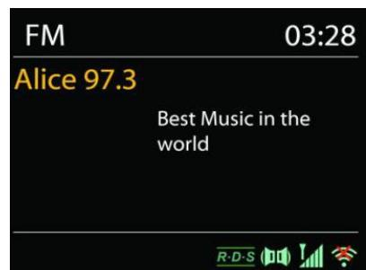
Pour rechercher une station de radio automatiquement, appuyez et maintenez le bouton "INTRO". L'affichage de la fréquence commence à fonctionner et mémorise toutes les stations disponibles. Pour un réglage manuel, appuyez sur «◀◀» ou «▶▶». L'appareil règle les émetteurs par pas de 0,05 MHz.
