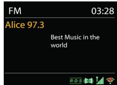
Pro ruční vyhledávání stiskněte a přidržte tlačítko „◀“ nebo tlačítko „▶“ na panelu nebo tlačítka dálkového ovladače „P+“ nebo „P-“. Spustí se zobrazení frekvence a prohledává se pásmo FM, přičemž se zastaví na další stanici.
