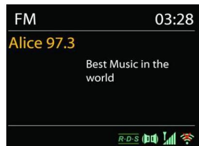
Om automatisch naar een radiostation te zoeken, houdt u de knop "INTRO" ingedrukt. De frequentieweergave begint te lopen en slaat alle beschikbare zenders op. Druk voor handmatig afstemmen op "◀" of "▶". Het apparaat stemt de zenders af in stappen van 0,05 MHz.
