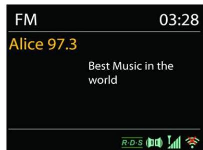
Na manuálne vyhľadávanie stlačte a podržte tlačidlo „◀◀“ alebo „▶▶“ na paneli, alebo tlačidlo „P+“, alebo „P-“ na diaľkovom ovládaní. Spustí sa zobrazenie frekvencie a vyhľadávanie celého pásma FM a zastaví sa na nasledujúcej stanici.
