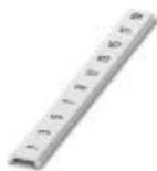
Zackband flach, Streifen, weiß, beschriftet, längs bedruckt: ungerade Zahlen 1-19, 21-39 usw. bis 81-99, Montageart: verrasten in flacher Schildchennut, für Klemmenbreite: 6,2 mm, Schriftfeldgröße: 5,15 x 6,15 mm, Anzahl der Einzelschilder: 10
