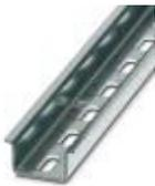
Tragschiene gelocht, Standardprofil, Breite: 35 mm, Höhe: 15 mm, ähnlich EN 60715, Material: Stahl, verzinkt, weiß-passiviert, Länge: 2000 mm, Farbe: silberfarben
