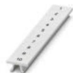
Zackband, Streifen, weiß, beschriftet, beschriftbar mit: CMS-P1-PLOTTER, quer bedruckt: fortlaufende Zahlen 1 ... 10, 11 ... 20 usw. bis 491 ... 500, Montageart: verrasten in hoher Schildchennut, für Klemmenbreite: 6,2 mm, Schriftfeldgröße: 6,15 x 10,5 mm, Anzahl der Einzelschilder: 10
