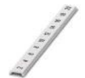
Zackband flach, Streifen, weiß, beschriftet, längs bedruckt: fortlaufende Zahlen 2 ... 20, 22 ... 40, usw. bis 82 ... 100, Montageart: verrasten in flacher Schildchennut, für Klemmenbreite: 6,2 mm, Schriftfeldgröße: 5,15 x 6,15 mm, Anzahl der Einzelschilder: 10
