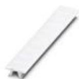
Marker für Klemmen, Streifen, weiß, beschriftet, beschriftbar mit: CMS-P1-PLOTTER, längs bedruckt: U, V, W, N, GND, U, V, W, N, GND, Montageart: verrasten in hoher Schildchennut, für Klemmenbreite: 6,2 mm, Schriftfeldgröße: 6,15 x 10,5 mm, Anzahl der Einzelschilder: 10
