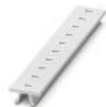
Zackband, Streifen, weiß, beschriftet, beschriftbar mit: CMS-P1-PLOTTER, längs bedruckt: gleiche Zahlen 1 oder 2 usw. bis 100, Montageart: verrasten in hoher Schildchennut, für Klemmenbreite: 6,2 mm, Schriftfeldgröße: 6,15 x 10,5 mm, Anzahl der Einzelschilder: 10
