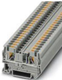
Durchgangsklemme, Nennspannung: 800 V, Nennstrom: 32 A, Anschlussart: Push-in-Anschluss, Anzahl der Anschlüsse: 2, Querschnitt: 0,2 mm<sup>2</sup> - 6 mm<sup>2</sup>, AWG: 24 - 10, Breite: 6,2 mm, Höhe: 35,3 mm, Farbe: grau, Montageart: NS 35/7,5, NS 35/15
