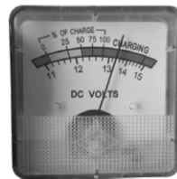
Figure 6 : La batterie est entièrement chargée
