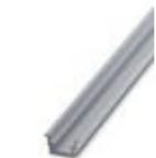
Tragschiene ungelocht, Standardprofil, Breite: 35 mm, Höhe: 15 mm, ähnlich EN 60715, Material: Aluminium, unbeschichtet, Länge: 2000 mm, Farbe: silberfarben
