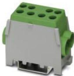
Hauptleitungs-Abzweigklemme, Nennspannung: 400 V, Nennstrom: 125 A, Anschlussart: Schraubanschluss, Schraubanschluss, Anzahl der Anschlüsse: 4, Polzahl: 1, Querschnitt: 10 mm<sup>2</sup> - 35 mm<sup>2</sup>, AWG: 8 - 2, Breite: 27 mm, Farbe: grün, Montageart: NS 35/7,5, NS 35/15
