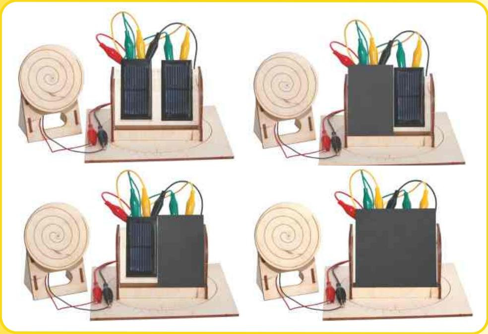
Wird bei der Parallelschaltung eine Solarzelle abgeschattet, reduziert sich die Gesamtleistung um diese Solarzellenleistung.
