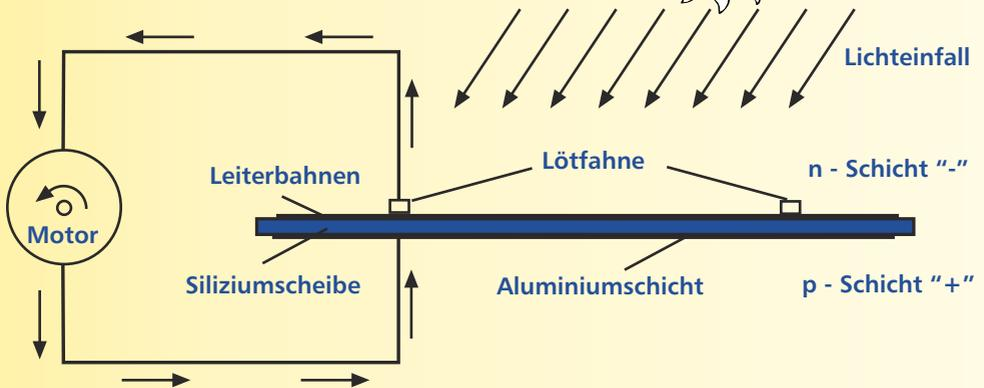
Eine Solarzelle produziert Gleichspannung. Je nach Qualität der Zelle kann diese Spannung zwischen 0,5 und 0,65 Volt liegen. Die Größe der Solarzelle bestimmt den Strom.
