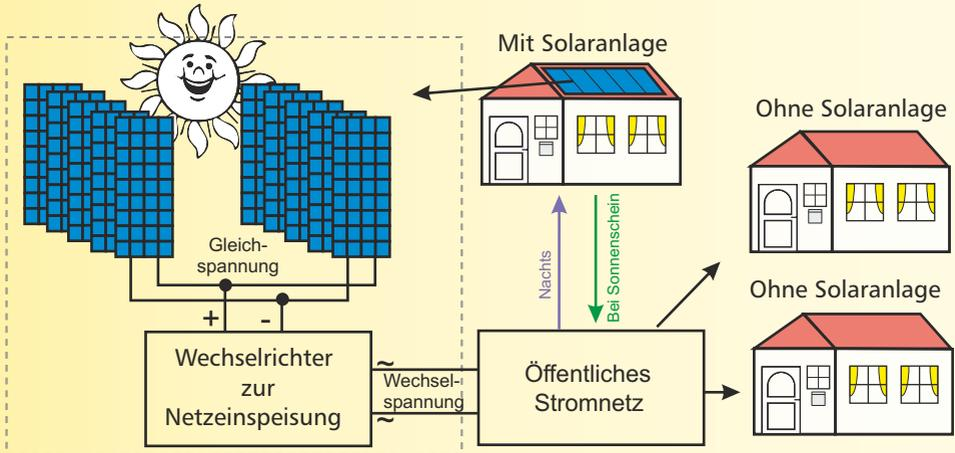
Der Wechselrichter zur Netzeinspeisung wandelt die **Gleichspannung in Wechselspannung** um und speist diese in das öffentliche Netz ein. Steht nicht genügend Energie durch die Solaranlage zur Verfügung, z.B. nachts oder bei schlechtem Wetter, bezieht der Betreiber der Anlage den Strom aus dem öffentlichen Netz.
