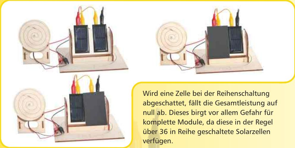
Wird eine Zelle bei der Reihenschaltung abgeschattet, fällt die Gesamtleistung auf null ab. Dieses birgt vor allem Gefahr für komplette Module, da diese in der Regel über 36 in Reihe geschaltete Solarzellen verfügen.
