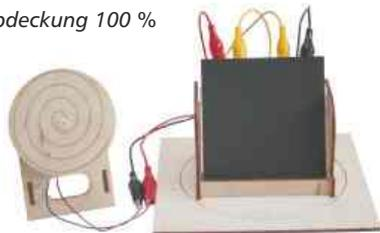
Je mehr eine Solarzelle abgeschattet wird, desto weniger Leistung erzeugt diese. Es ist daher immer darauf zu achten, verschattungsfreie Standorte für Solarmodule zu wählen.
