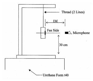
1 METER FROM MICROPHONE TO FAN INTAKE
