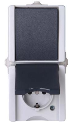
Aufputz-Feuchtraum Aus-/Wechselschalter-Steckdosenkombination im Design proAQA und der Farbe grau in senkrechter Ausführung ohne erhöhtem Berührungsschutz, Nennspannung liegt bei 250V~. Schaltvermögendes Schalters liegt bei 10AX und der Nennstrom der Steckdose liegt bei 16A. Schutzart IP44
