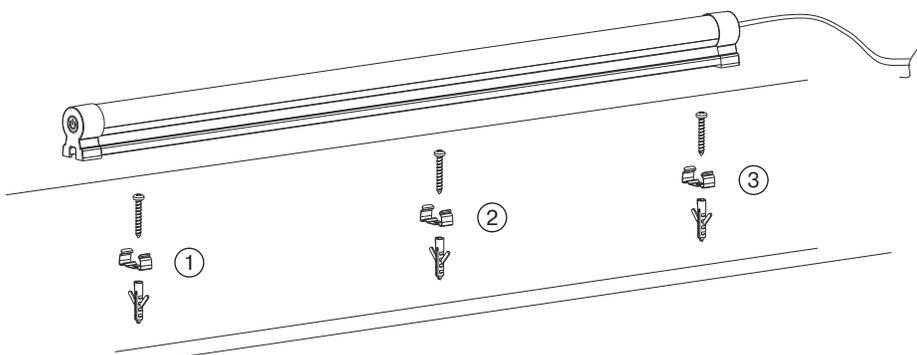
Befestigen Sie zuerst die beiden äußeren Halteclips (1+3), um die Leuchte gegen Verrutschen zu sichern, befestigen Sie danach den Halteclip (2) in der Mitte.
