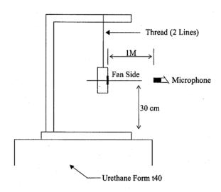
1 METER FROM MICROPHONE TO FAN INTAKE
