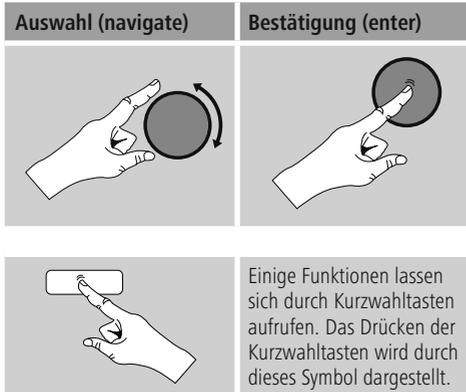
Navigieren Sie nach Druck auf eine Kurzwahl-taste mit **[ENTER/NAVIGATE]** durch die angebotenen Menüpunkte.
