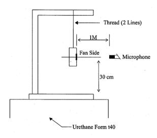
1 METER FROM MICROPHONE TO FAN INTAKE
