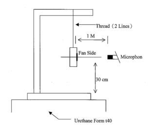
1 METER FROM MICROPHONE TO FAN INTAKE
