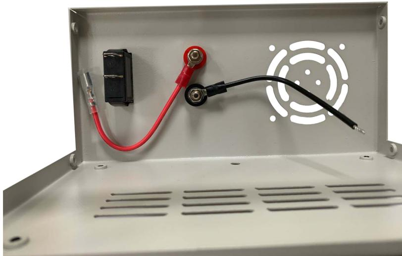
4. Nun werden die Kabel mit den Flachsteckhülsen am Kippschalter befestigt. Dabei ist zu beachten, dass das Kabel von der Buchse an der 0-Position befestigt wird und das andere an der 1-Position. Danach stecken Sie das RD6006 in das Gehäuse um es zu befestigen. Nun können Sie die letzten losen Kabelenden am Modul selbst anbringen, nämlich am Stromeingangsterminal. Dabei ist zu beachten, dass das rote Kabel in + und das schwarze in - geschraubt werden muss.
