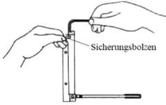
Den Federtürschließer „mittig“ am Türrahmen montieren. Der Federtürschließer ist für Türen mit rechts-, oder links Anschlag geeignet. Nach der Montage kann mit dem beiliegenden Sechskantschlüssel die Schließstärke durch an-, oder entspannen der Feder individuell eingestellt werden (Skizze). Vor dem einstellen der Schließstärke muss der Sicherungsbolzen durch leichtes anspannen entnommen werden.
