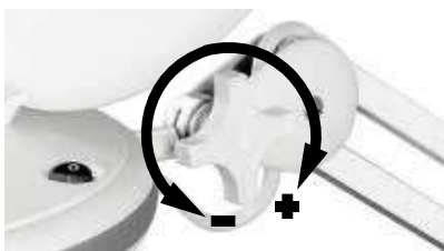
Fig.43: Conectar las piezas individuales - bloquear
