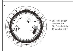
GB: Set timer, push indicator outside (each indicator 15 min) DE: Timereinstellung, drücken Sie die Anzeige nach außen (jede Anzeige 15 Minuten).
