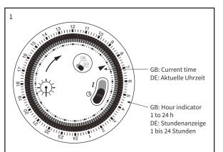
GB: Connect power and set hour indicator according to actual time DE: Schließen Sie die Stromversorgung an und stellen Sie die Stundenanzeige entsprechend der tatsächlichen Uhrzeit ein.
