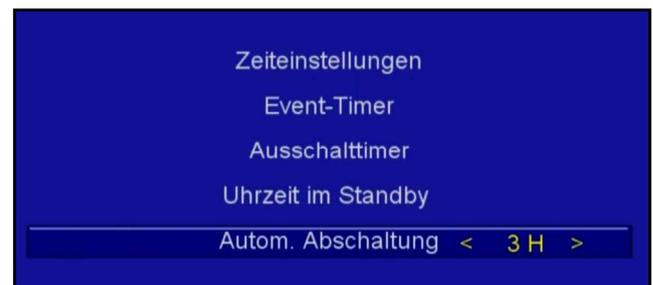
Sie zwischen **15 M**, **30 M**, **1 H**, **2 H**, **3 H** und **4 H** (M=Minuten / H= Stunden). Steht die Auswahl auf „AUS“, so ist die **Autom. Anschaltung** deaktiviert. In der Auswahl „--“ können Sie manuell über die 10er-Tastatur die Minutenzeit eingeben. Bestätigen Sie Ihre Auswahl mit der Taste **OK**. Voreingestellt ist das Gerät auf **3 H**. Das Gerät schaltet sich nach **3 Stunden** von selbst aus, wenn keine Bedienung über die Fernbedienung oder am Gerät vorgenommen wurde.
