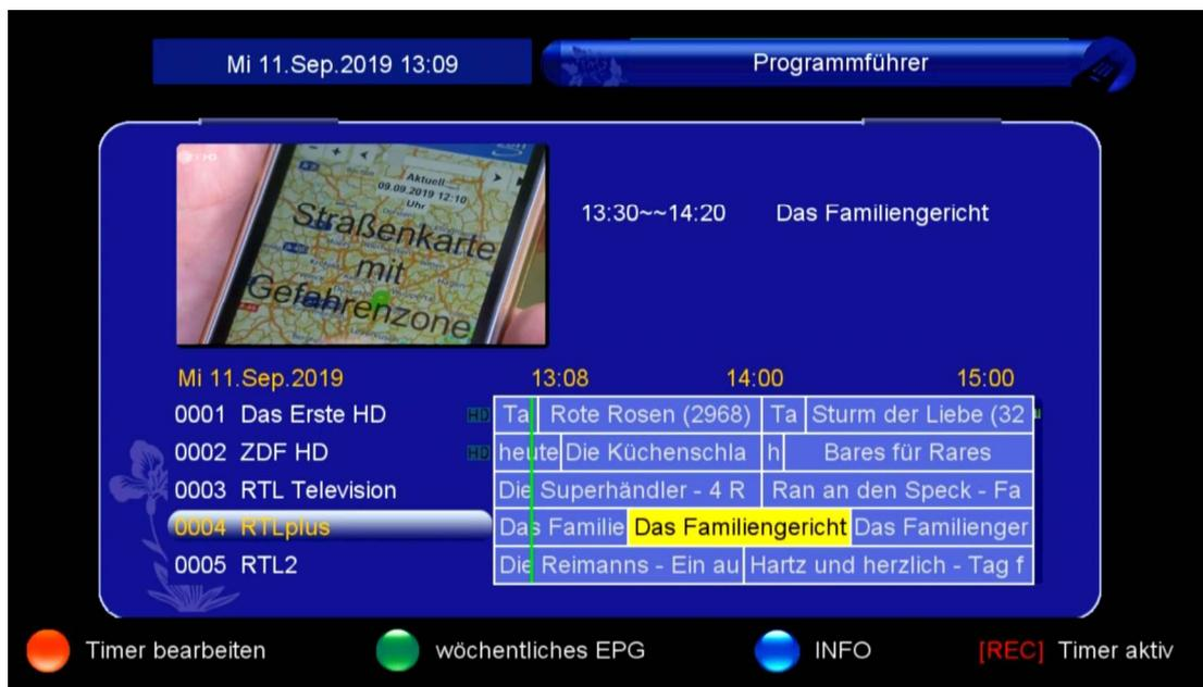
Navigieren Sie mit den Tasten **▲ / ▼ / ◀ / ▶** auf die Sendung, die Sie für die Timerprogrammierung programmieren wollen (Hier im Beispiel: **13:30-14:20** Uhr auf **RTL plus** „**Das Familiengericht**“ ). Drücken Sie die **ROTE** Taste um diese Sendung für die Aufnahme zu programmieren .
