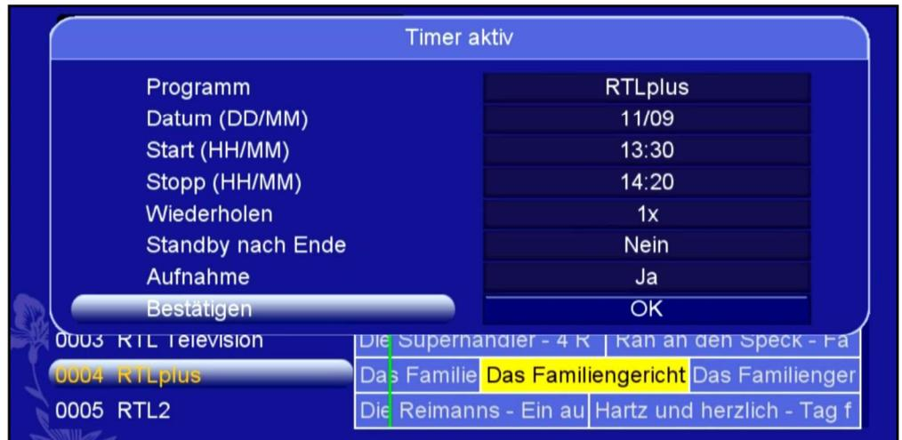
Der Receiver hat selbstständig das Programm, das Datum, die Startzeit und die Stoppzeit aus dem EPG ausgelesen und gesetzt. Sie können nun mit den Tasten ▲ / ▼ folgende Menüpositionen ändern:
