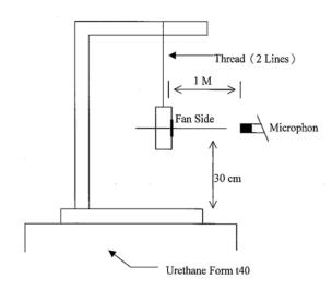
1 METER FROM MICROPHONE TO FAN INTAKE
