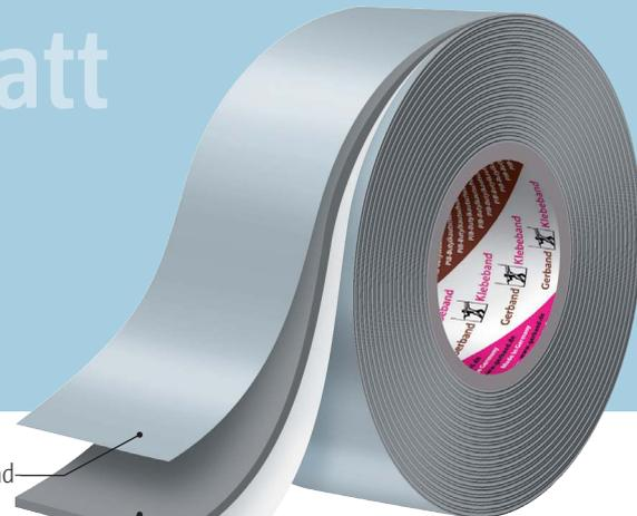
Gerband 606 ist ein dauerhaft wasserbeständiges Aluminium-Butyl-Dichtband mit sehr hoher Oberflächenklebrigkeit und sehr hoher Alterungsbeständigkeit. Es wird unter anderem zum Abkleben von Fugen und Anschlüssen gemäß DIN 4108-7 im Hochbau verwendet.
