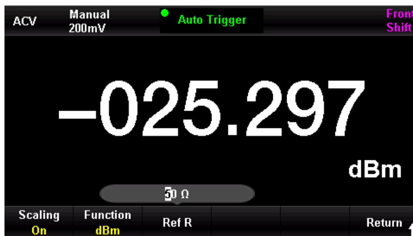
Abbildung 4-5 Menü zur dBm-Messung
