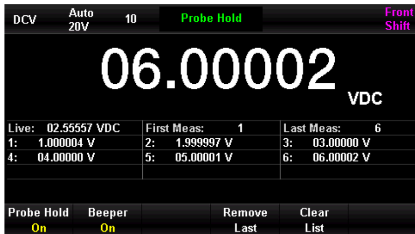
Abbildung 4-10 Menü zur DCV-Halten-Messung
