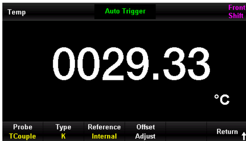
Abbildung 4-12 Menü zur Temperaturmessung mit Thermoelement Typ K
