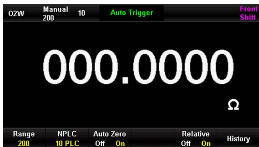
Abbildung 4-4 Widerstandsmessung nach Relativbetrieb
