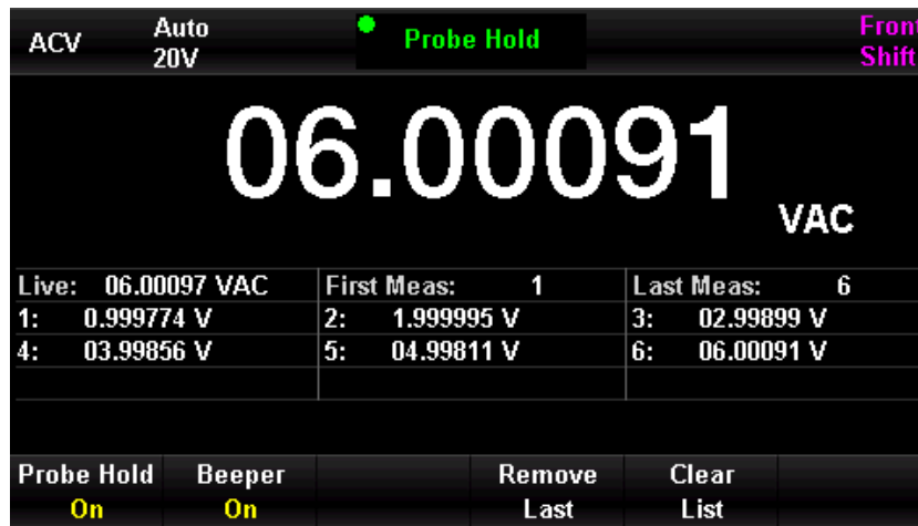
Abbildung 4-11 Menü zur ACV-Hold-Messung
