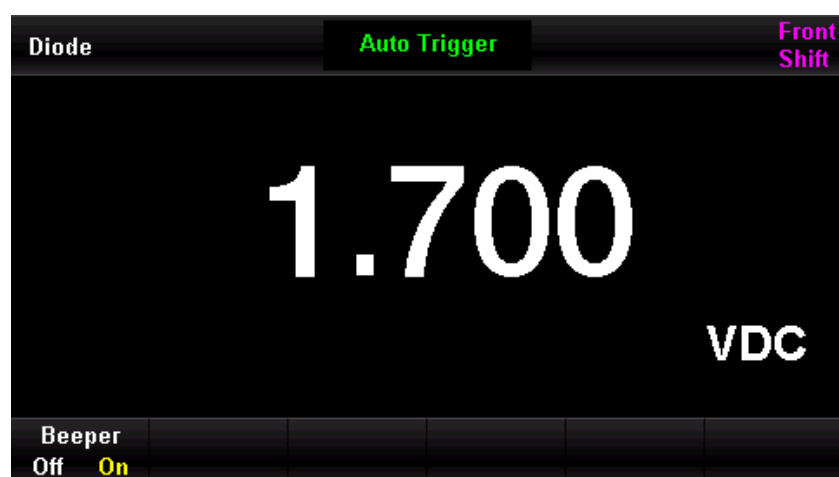
Abbildung 2-8 Messung der Durchbruchspannung der Diode
