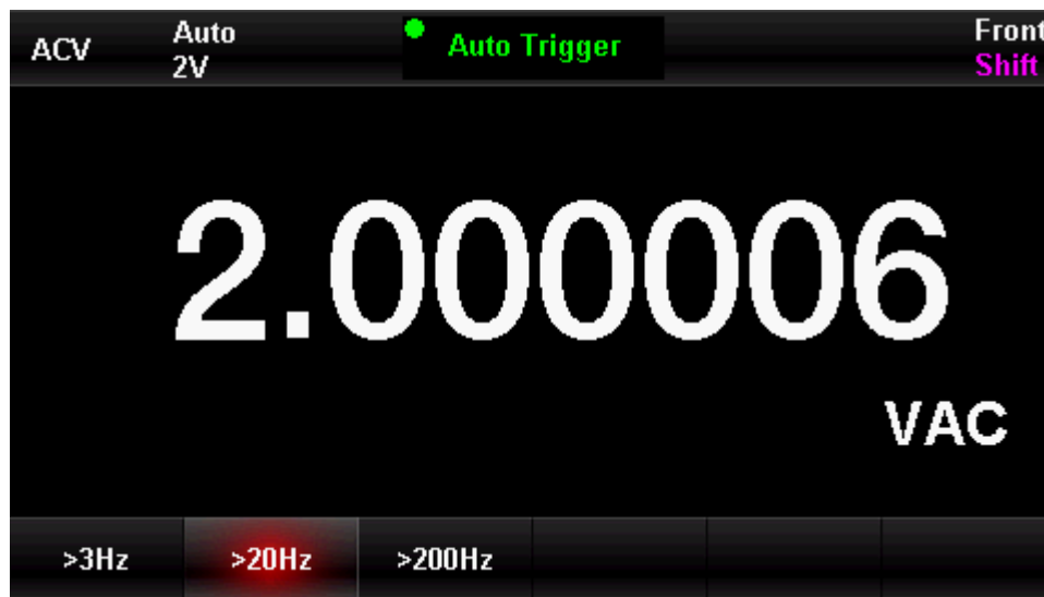
Abbildung 2-6 Einstellung des Niederfrequenzfilters
