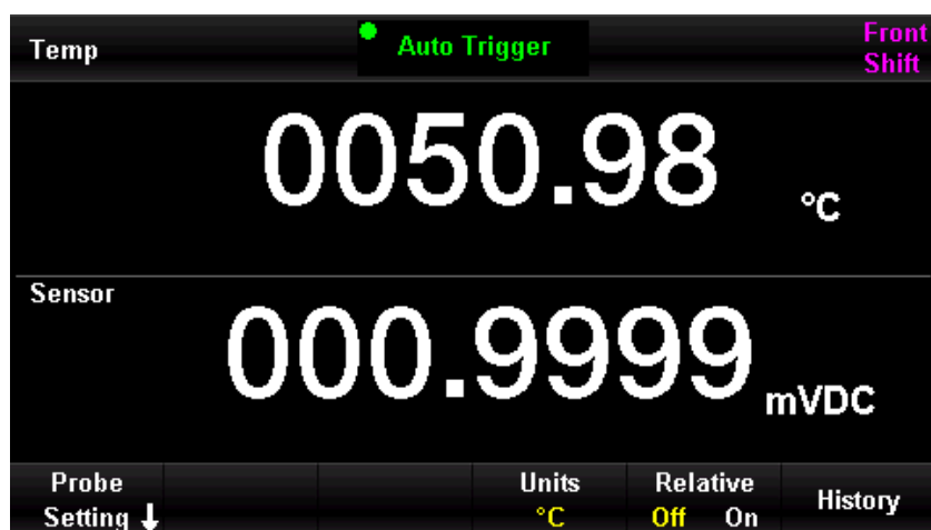
Abbildung 4-142 Duale Anzeige der Temperaturmessung, Menü 2
