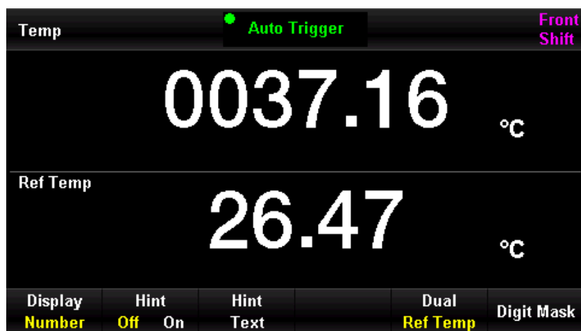
Abbildung 4-13 Duale Anzeige der Temperaturmessung, Menü 1
