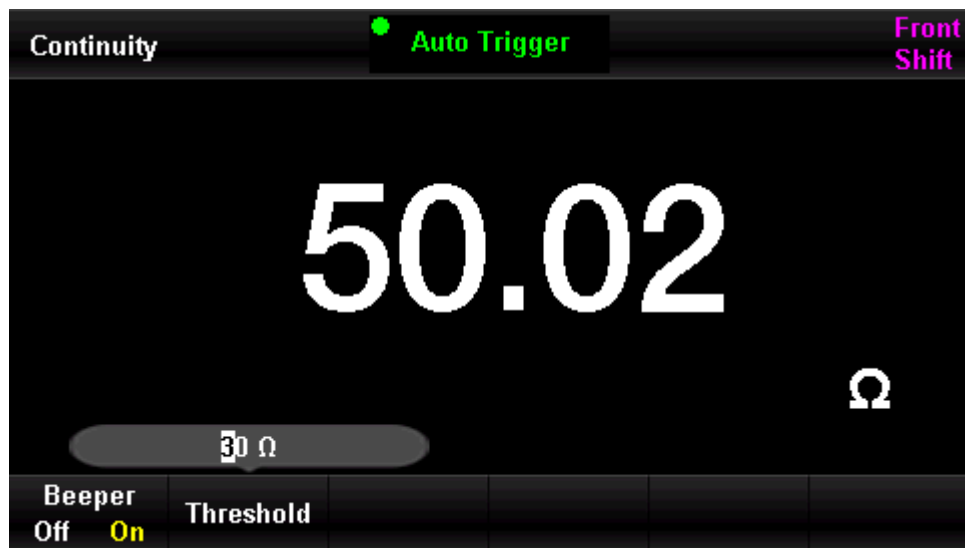
Abbildung 2-7 Einstellung des Kurzschlusswiderstandes
