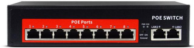
Der PS108 100 Mbit/s Standard PoE Switch bietet Ihnen 10 adaptive 10/100M RJ45-Ports. Die Ports 1 bis 8 verfügen über eine PoE-Stromversorgung. Alle PoE-Ports können Geräte die über IEEE802.3at/af Standards verfügen automatisch erkennen und gegebenenfalls mit Strom über die Netzwerkleiste versorgt. Der Switch unterstützt außerdem den Switch Modus (VLAN Isolation). Dieser kann Leistungen bis 150m übertragen. Des Weiteren besitzt der Switch zwei wählbare Modi.
