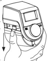
Das Batteriesymbol im Display weist darauf hin, dass die Batterien auszutauschen sind. Nach Entnahme der leeren Batterien sollte bis zum Einlegen der neuen Batterien ca. 1 Minute gewartet werden. Ein Betrieb mit Akkus ist nicht möglich.
