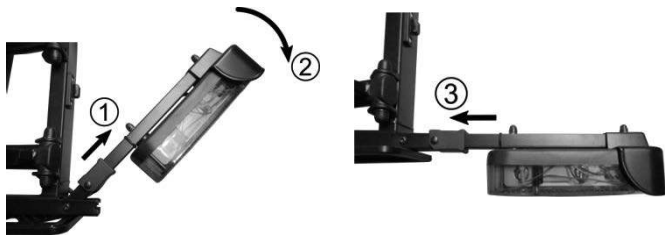
Bild 12: Verriegelung Leuchtenträger
