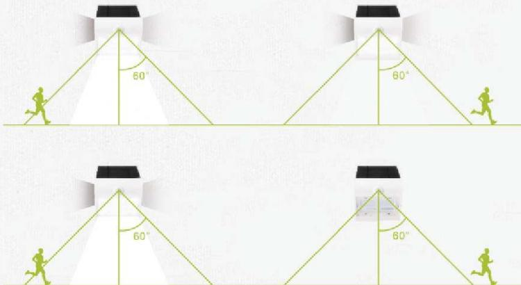
**Modus A:** Schaltet auf volle Helligkeit (220 lm), wenn im Bereich von 6 m Bewegung erfasst wird. Nach 10 Sekunden ohne weitere Bewegung wird die vordere und hintere Beleuchtung gedimmt.
