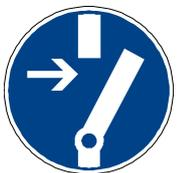
Schließen Sie das Produkt nur an Stromkreise an, die mit einem allpolig trennenden Schalter abschaltbar sind. Bei Arbeiten am Produkt müssen Sie die Anlage/Maschine, in die das Produkt eingebaut ist, gegen Wiedereinschalten sichern.
