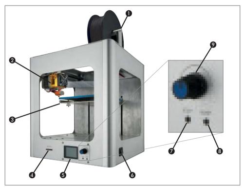
**Filament-Halter** Hier wird die Filament-Rolle angebracht.
