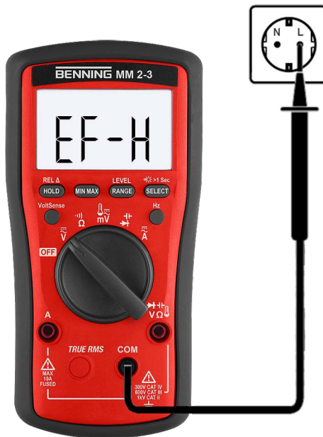
Abb. 15: Außenleiter- oder Phasenprüfung
