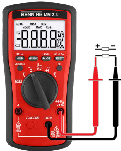
Abb. 11: Widerstandsmessung oder Durchgangsprüfung
