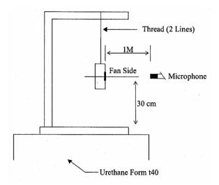
1 METER FROM MICROPHONE TO FAN INTAKE
