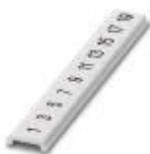
Zackband flach, Streifen, weiß, beschriftet, längs bedruckt: ungerade Zahlen 1-19, 21-39 usw. bis 81-99, Montageart: verrasten in flacher Schildchennut, für Klemmenbreite: 4 mm, Schriftfeldgröße: 5,15 x 4,15 mm, Anzahl der Einzelschilder: 10
