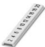
Zackband flach, Streifen, weiß, beschriftet, längs bedruckt: fortlaufende Zahlen 2 ... 20, 22 ... 40, usw. bis 82 ... 100, Montageart: verrasten in flacher Schildchennut, für Klemmenbreite: 4 mm, Schriftfeldgröße: 5,15 x 4,15 mm, Anzahl der Einzelschilder: 10
