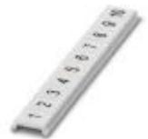
Zackband flach, Streifen, weiß, beschriftet, längs bedruckt: fortlaufende Zahlen 1 ... 10, 11 ... 20 usw. bis 91 ... 100, Montageart: verrasten in flacher Schildchennut, für Klemmenbreite: 4 mm, Schriftfeldgröße: 4,2 x 5,2 mm, Anzahl der Einzelschilder: 10
