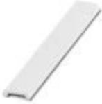
Zackband flach, Streifen, weiß, unbeschriftet, beschriftbar mit: CMS-P1-PLOTTER, PLOTMARK, Montageart: verrasten in flacher Schildchennut, für Klemmenbreite: 4 mm, Schriftfeldgröße: 4,2 x 5,2 mm, Anzahl der Einzelschilder: 10
