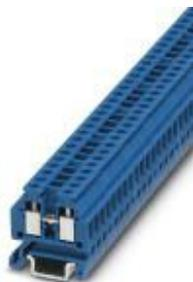
Microklemme, Nennspannung: 400 V, Nennstrom: 17,5 A, Anschlussart: Schraubanschluss, Anzahl der Anschlüsse: 2, Querschnitt: 0,14 mm<sup>2</sup> - 1,5 mm<sup>2</sup>, AWG: 26 - 16, Breite: 4,2 mm, Farbe: blau, Montageart: NS 15
