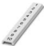
Zackband flach, Streifen, weiß, beschriftet, quer bedruckt: fortlaufende Zahlen 1 ... 10, 11 ... 20 usw. bis 91 ... 100, Montageart: verrasten in flacher Schildchennut, für Klemmenbreite: 4 mm, Schriftfeldgröße: 4,2 x 5,2 mm, Anzahl der Einzelschilder: 10
