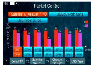
Auf dem Bildschirm werden die Signalstärke S und die Signalqualität Q von fünf aufeinanderfolgenden Transpondern angezeigt.
