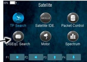
Die DiSEqC-Suche beginnt automatisch. Nacheinander werden alle vier DiSEqC1.0-Anschlüsse gescannt. Nach Abschluss des Scanvorgangs, sehen Sie welche Satelliten empfangbar sind.
