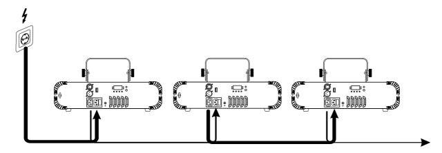
Das Gerät verfügt über ein Schaltnetzteil, das eine Netzspannung zwischen 100 und 240 Volt erlaubt.
