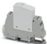
Überspannungsschutz Typ 2/3, bestehend aus Schutzstecker und Basiselement mit Schraubanschluss. Für einphasige Stromversorgungsnetze mit integrierter Statusanzeige und Fernmeldung. Nennspannung 230 V AC/DC.
