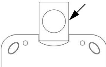
Dieses Modell verfügt auf der Rückseite über eine herausziehbare Aufhängevorrichtung.
