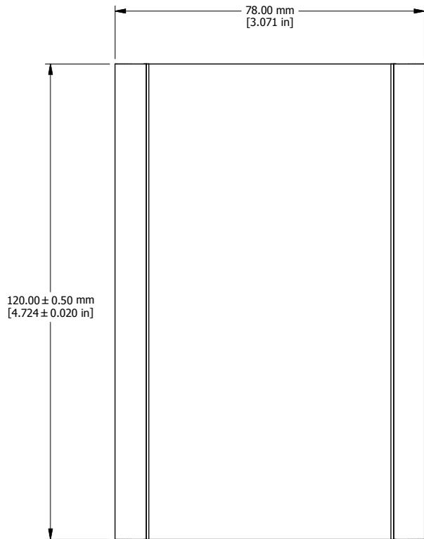
EXTRUSION DESIGNED FOR 75MM WIDE PC BOARD
