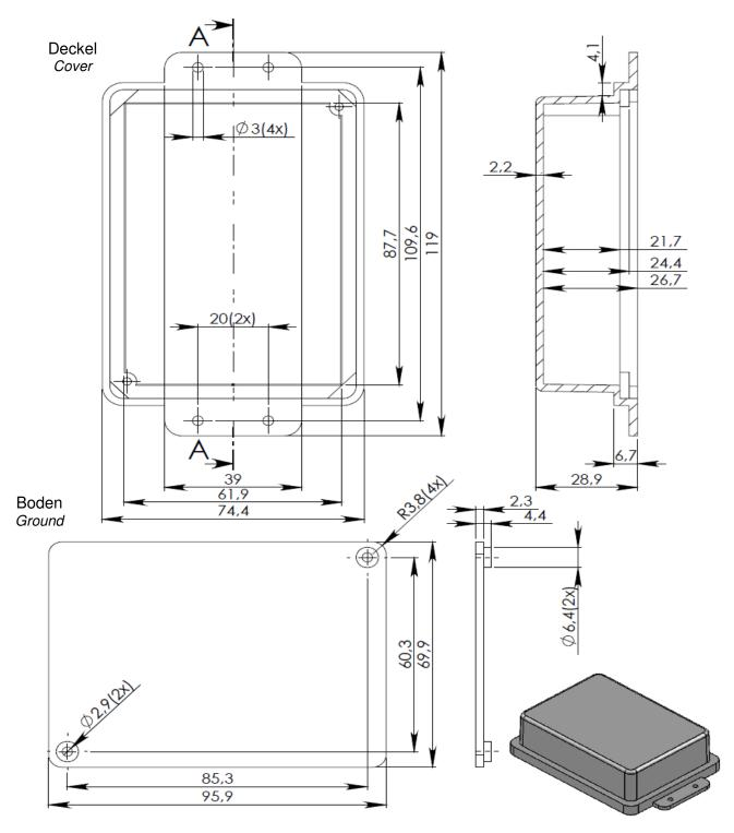
Modulgehäuse (z.B. zum Einbau von elektronischen Baugruppen) mit Bodenplatte und seitlichen Laschen zur schnellen Befestigung.
