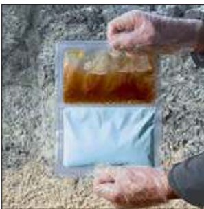
Transparenter 2-Kammer-Beutel zur besseren Kontrolle des Mischvorgangs.
