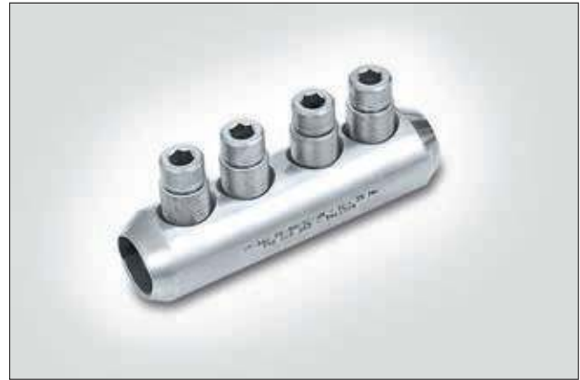
Verzinnte Schraubverbinder mit Trennsteg und Abreißschrauben für Al- und Cu-Leiter.
