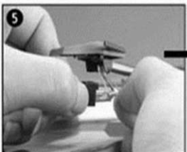
Drücken Sie die Armsperre, um den Tonarm zu lösen.
