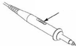
Die Optionen sind 1X und 10X. Wenn der Dämpfungsschalter auf 1x gestellt ist, limitiert der Tastkopf die Bandbreite des Oszilloskops auf 6MHz. Um die volle Bandbreite des Geräts zu nutzen, stellen Sie sicher, den Schalter auf 10X zu stellen.
